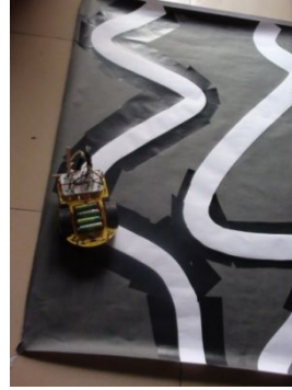
图 27 机器人跑白线实物图（技术方案二）
